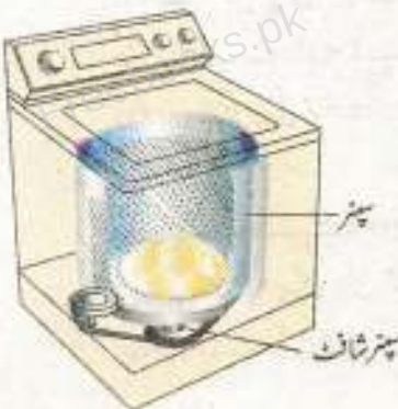
شکل 3.30: واشنگ مشین کے ڈرائیئر کی دیواریں سوراخ دار ہوتی ہیں۔
