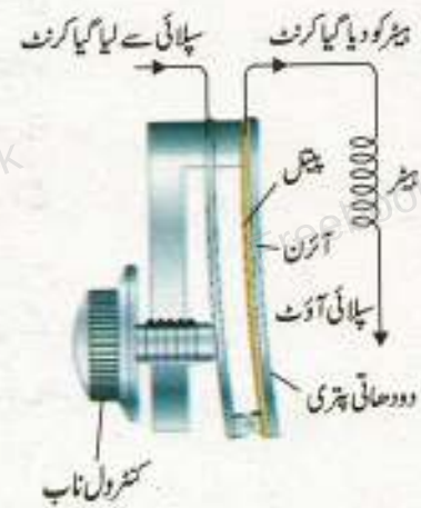
شکل 8.20: دو دھاتی تھرمو سٹیٹ پہلے سے سیٹ کیے گئے ٹھنڈی پر الیکٹرک سرکٹ کو کات دیتا ہے۔
